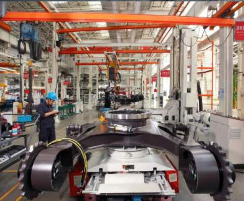
Na plataforma é utilizada borda tipo D reforçada, placa de aço de alta resistência e um design anti-colisão na viga da borda. O testes de resistência e experimentos simulam as condições reais de aplicação, garantindo assim alta resistência e alta segurança do conjunto.
